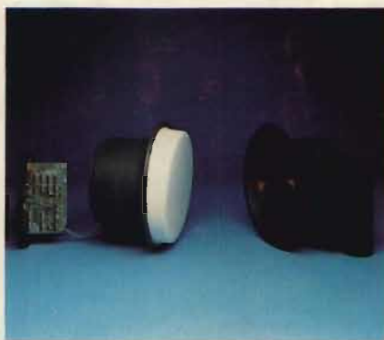
Particolari ERT 12A: Circuito digitale di controllo e paraboloido senza «radome» con vista dell'illuminatore.
